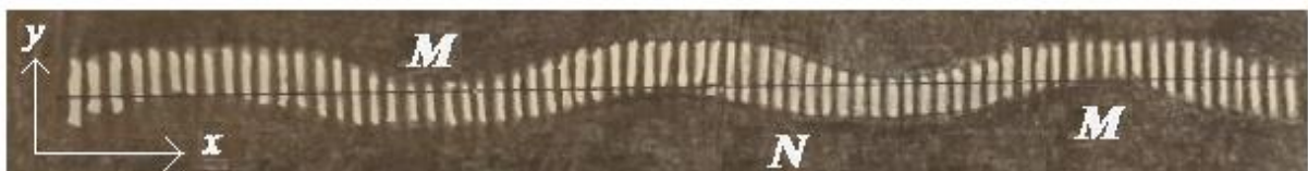
Рис.1. Фотография [5] винтовой дуги в канале, снятой через витки обмотки соленоида.
