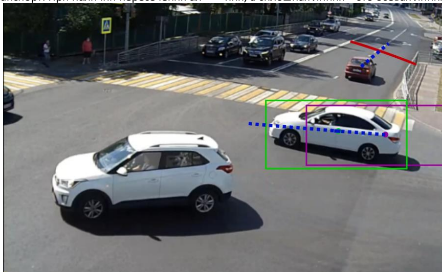
Рисунок 3. Принцип работы алгоритма «Алгоритм подсчета автотранспорта на основе пересечения осевой линии предсказанной траекторией движения»
