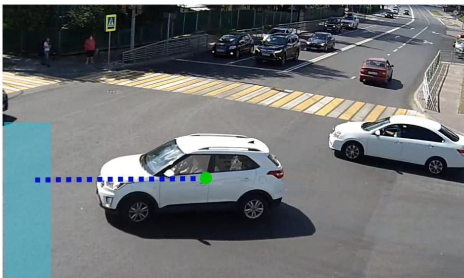
Рисунок 4. Принцип работы алгоритма «Алгоритм подсчета на основе попадания предсказания следующей точки траектории движения автотранспорта в заранее определенную область»
