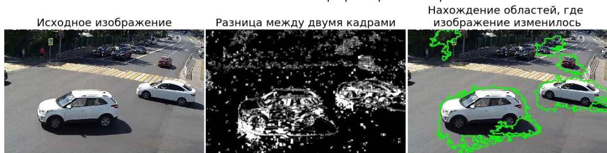
Рисунок 1. Пример работы алгоритма «Алгоритм подсчета на основе отслеживание движения автотранспорта с помощью сравнения двух кадров»
