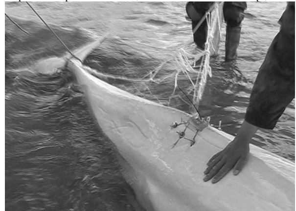
Рис. 1. ДСТ SPOT 4 типа «паук», установленный на белуху. Белое море, 2005 г.
