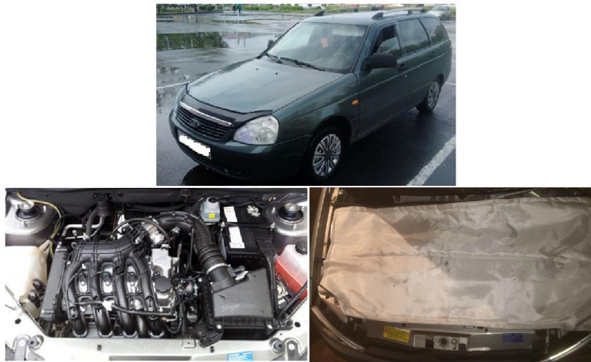
Рис 2.Объекты исследования: автомобиль ВАЗ (LADA) Приора-2171; двигатель ВАЗ 21126 без термоизолирующих компонентов; двигатель ВАЗ 21126 с термоизолирующими компонентами
