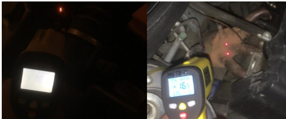
Рис.6. Замеры пирометром теплового баланса точек двигателя ВАЗ 21126 без термоизолирующего одеяла
