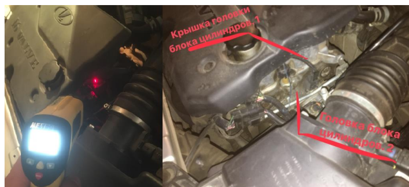
Рис.8. Замеры пирометром теплового баланса точек двигателя ВАЗ 21126 без термоизолирующего одеяла
