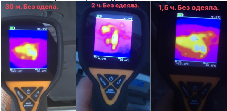
Рис.5. Термографии двигателя ВАЗ 21126 без термоизолирующего одеяла
