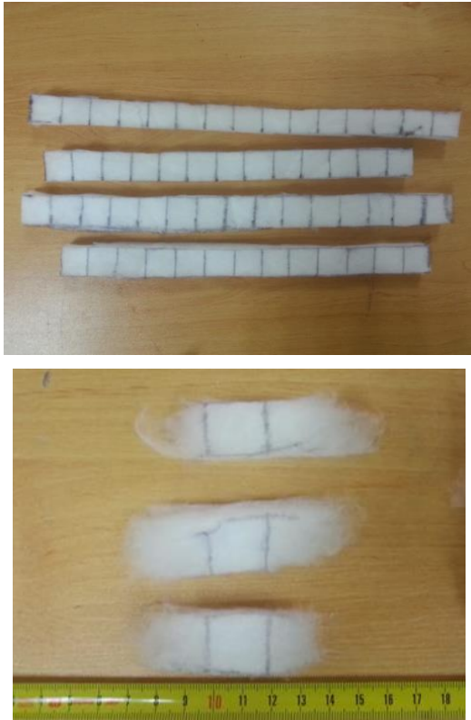
Рис. 3. Комбинированные кластеры, полученные разрывом предварительно нарезанных полос
