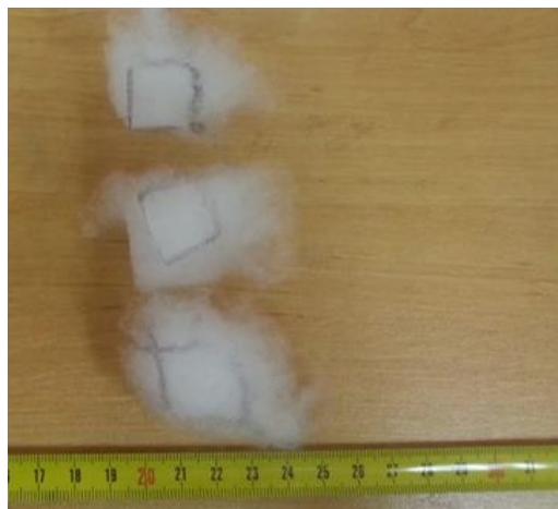
Рис. 2. Измельчение нетканого полотна на кластеры гребёнкой
