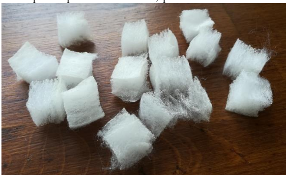
Рис. 1. Прямоугольные чипсы, полученные нарезанием из нетканого полотна
