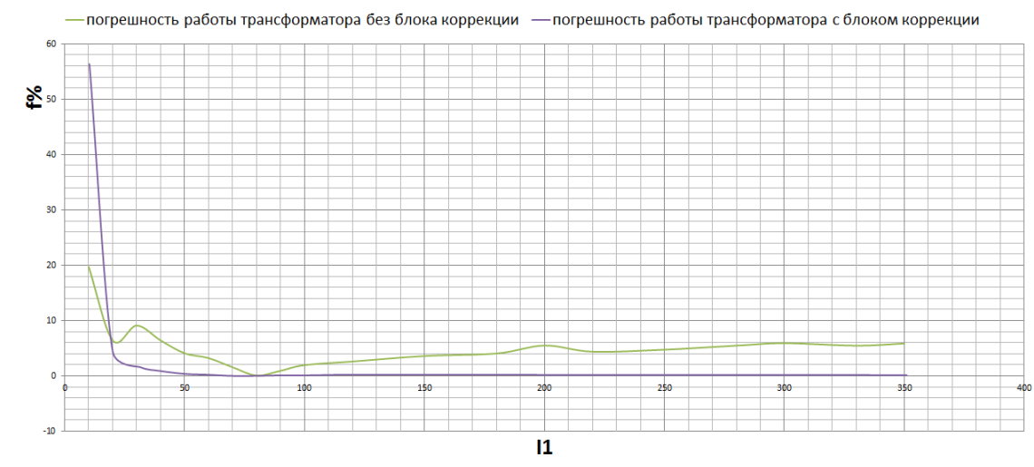
Рис. 3.2. Анализ погрешности работы трансформатора.
