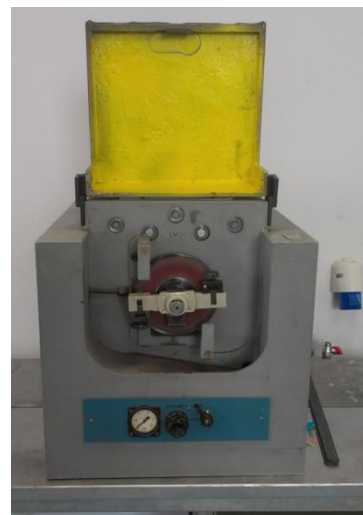
Рис.1- Испытательная машина на трение 2120 ТП [1, с. 106]
