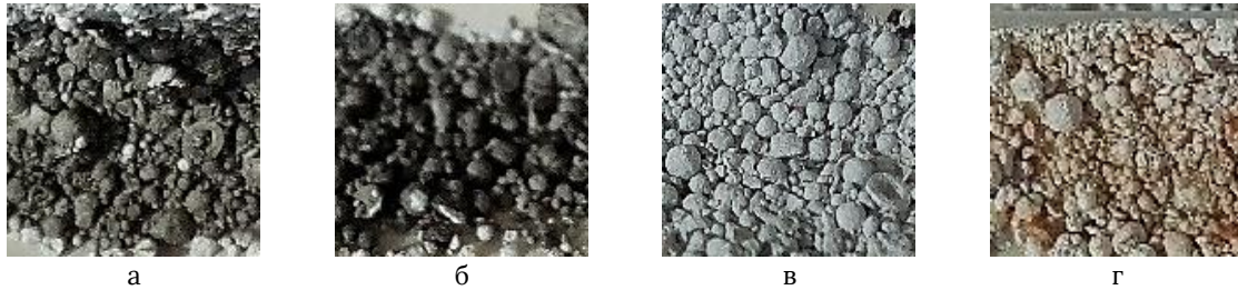
Рис. 2. МКУ-85 обожжённый при температуре: а – 1000 °С; б – 1050 °С; в – 1080 °С; г – 1200 °С
