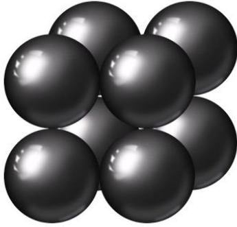
Рис. 2. Кубическая укладка шариков в слое
