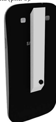
Рис. 3. Мини-спектрометр укрепленный на смартфоне
