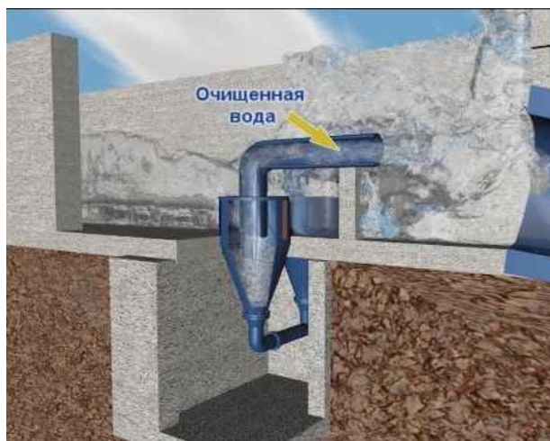
Рис. 3 - Узел расположения гидроциклонов в деривационном канале мини ГЭС
